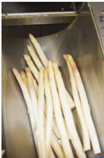
◀ Qualitätskontrolle: Automatische Sortierung der Stangen nach Dicke und Länge
