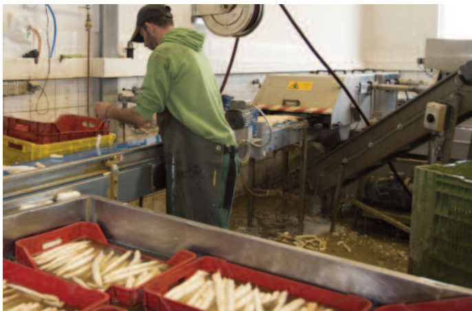
◀ Qualitätskontrolle: Automatische Sortierung der Stangen nach Dicke und Länge
